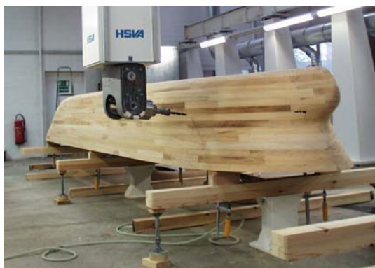
Fertigung eines Schiffsmodells mit der Computer-gesteuerten Fräse
