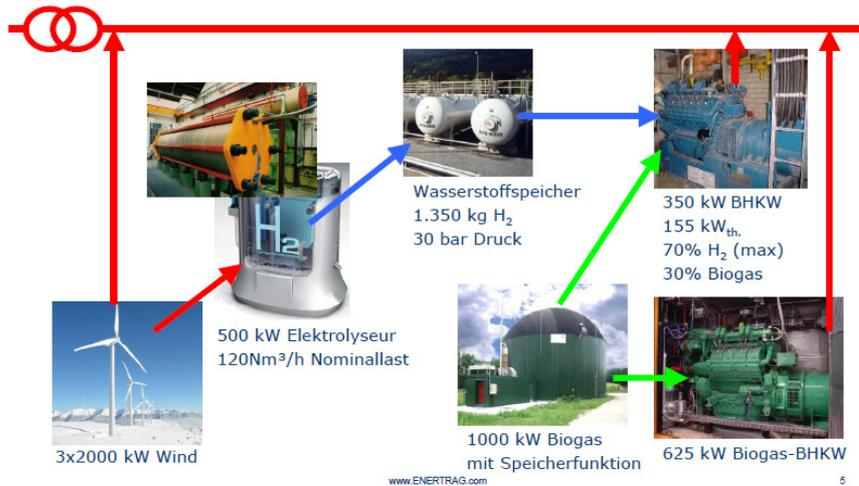
Abbildung 42: Anlagenkonfiguration für eine netzgerechte Stromversorgung, Anlage Enertrag in Prenzlau
