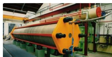
Alkalischer Wasserelektrolyseur (Fa. Lurgi)
