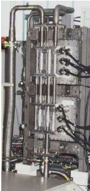
240KW-PEM-Brennstoffzellenanordnung mit doppelwandiger Gasleitungen Foto: HDW - Fuel Cell Systems
