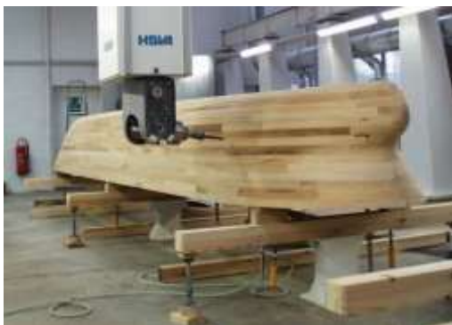
Fertigung eines Schiffsmodells mit der Computer-gesteuerten Fräse
