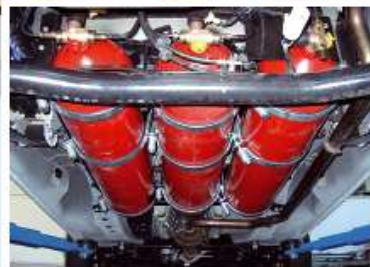
Anordnung der Wasserstoff-Gastanks unter dem Fahrzeug – kein Verlust an Laderaum.
