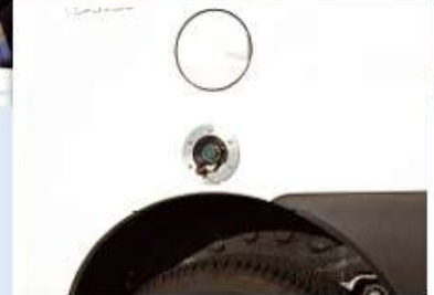
Für den Wasserstoff gibt es einen Tankstutzen extra.
